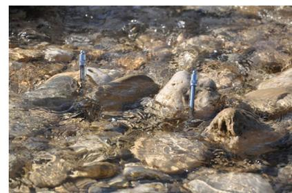
Figure 4 : thermomètres mesurant la température de l'eau. © Daria Göllnitz / GLOBE Suisse
